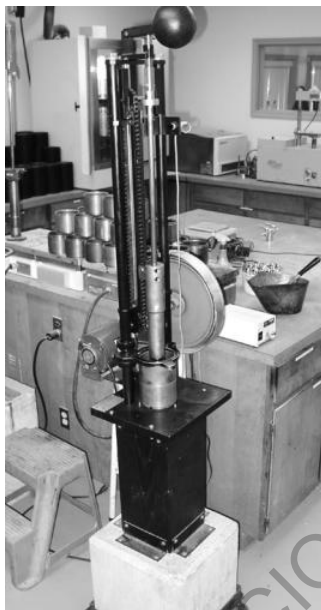
Figura 748 - 3. Martillo mecánico de compactación Marshall
