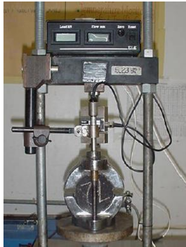
Figura 748 - 12. Aplicación de carga a la probeta Marshall
