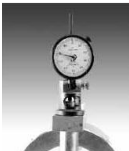
Figura 748 - 7. Deformímetro para medir el flujo
